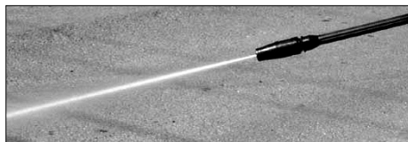
Figure 3 - Jet étroit à impact élevé
